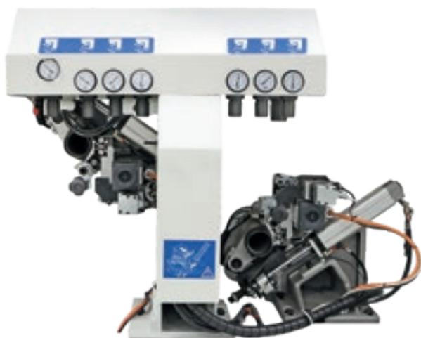
Закругляющая Многофункциональная Группа для радиусной обработки, не только в начале и конце панели, а ещё и по её верхней и нижней частям.
